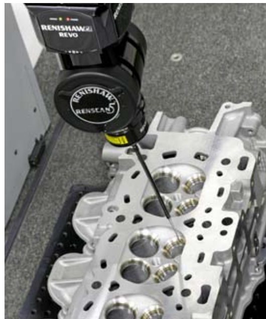
REVO® Fünf-Achsen-Mess-System bei der Messung eines Ventilsitzes
