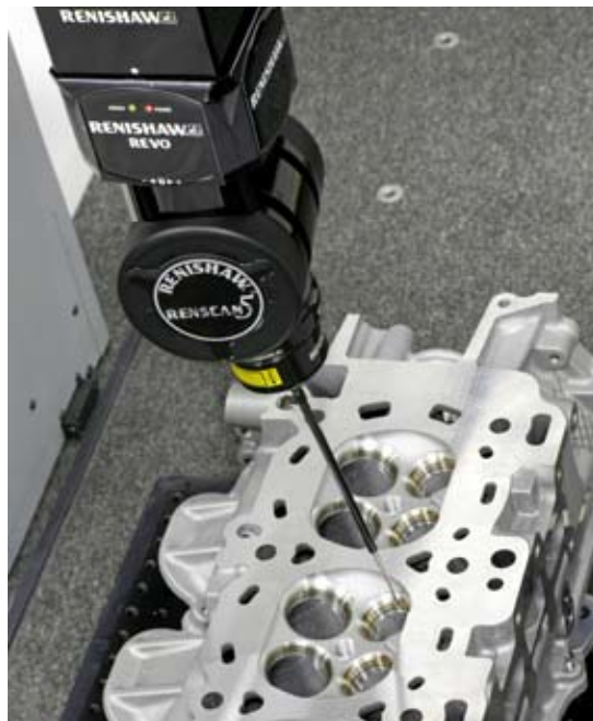
REVO® système 5 axes mesurant un siège de soupape
