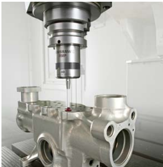
RMP40 palpeur ultra-compact à transmission radio
