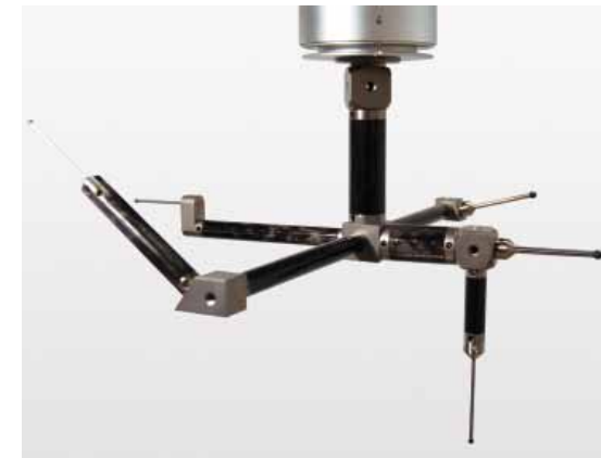
Eine komplexe Tastereinsatzkonfiguration mit verschiedenen Komponenten
