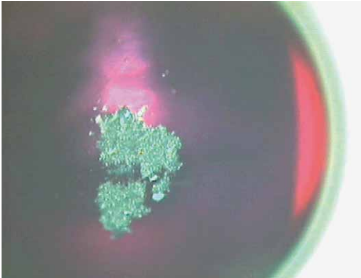
Typische Ablagerungen an einer Rubinkugel nach einem Scan- Einsatz von 350 m
