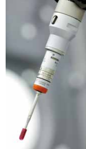
Zylindrische Tastereinsätze zur Messung von Blechkomponenten
