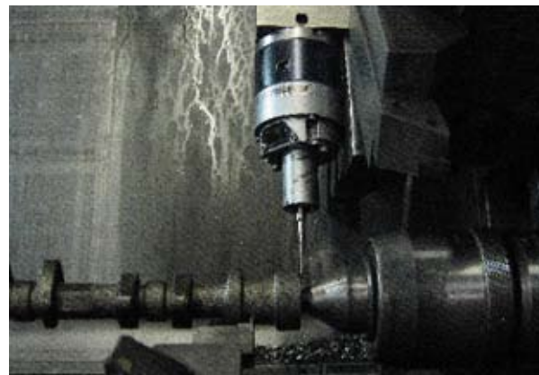
Messtastersystem LTO2S von Renishaw auf einer Doppelrevolver-CNC-Drehmaschine – präzises Orten der Vorderfläche vor der Bearbeitung bei einer Zykluszeit von 90 Sekunden.
