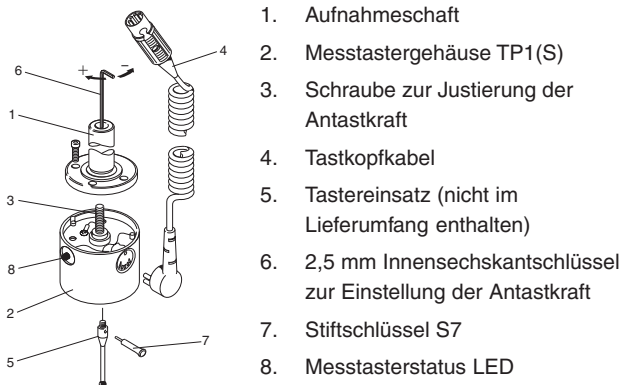
Abbildung 2 – Taktile schaltender Messtaster TP1(S)
