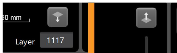
Figura 40 Pulsanti “Z cut plane” (Piano di taglio Z) e riquadro dello strato corrente
