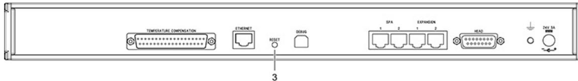
Nummer 3 auf der Rückseite ist die Reset-Taste, die zwei unterschiedliche Funktionen hat. Die Funktion richtet sich nach dem Betriebszustand der Steuerung.
