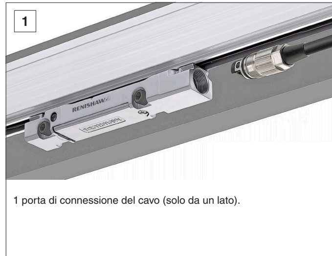
Inserire il cavo nel lettore. Controllare che il connettore sia orientato in modo corretto: il taglio deve essere rivolto verso la base del lettore.
