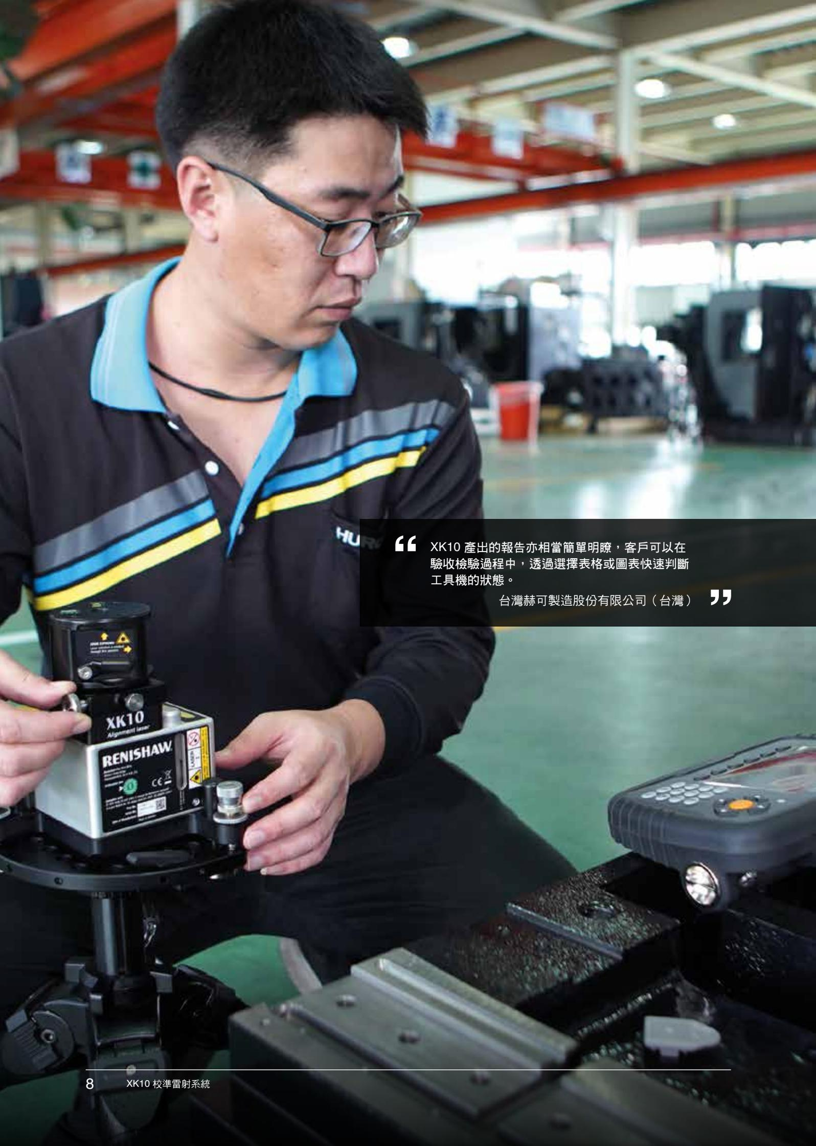
“ XK10 產出的報告亦相當簡單明瞭，客戶可以在驗收檢驗過程中，透過選擇表格或圖表快速判斷工具機的狀態。
