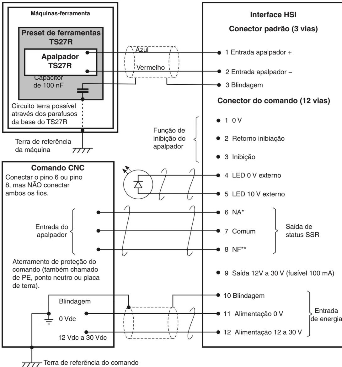
**NOTA:** Ao conectar o apalpador TS27R à interface HSI, use a conexão denominada STANDARD PROBE.
