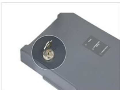
MCU W-2锁定位置“开启”，操纵杆已启用
