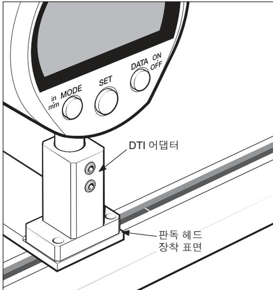
2. 2.5 mm의 설치 높이에서 측정된 거리를 빼서 필요한 심 두께를 계산합니다. 예를 들어, 측정된 거리가 2.37 mm인 경우 필요한 심 두께는 130 μm입니다.
