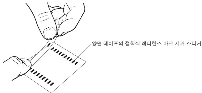
4. 아래 그림처럼 필요하지 않은 레퍼런스 마크 위 스케일에 맞춰 스티커를 정렬한 다음 스티커가 스케일에 부착될 때까지 어플리케이터 필름을 강하게 문지릅니다. 스티커가 레퍼런스 마크를 완전히 덮고 증분 트랙을 가리지 않도록 주의합니다.
