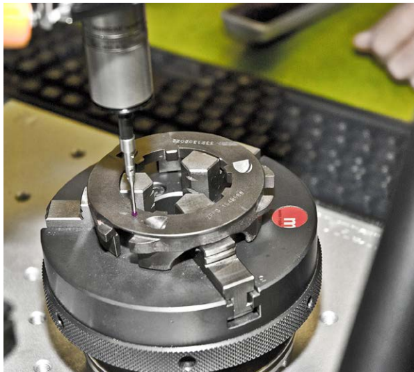
Equator 檢具系統正在量測 ZF Marine 的工件
