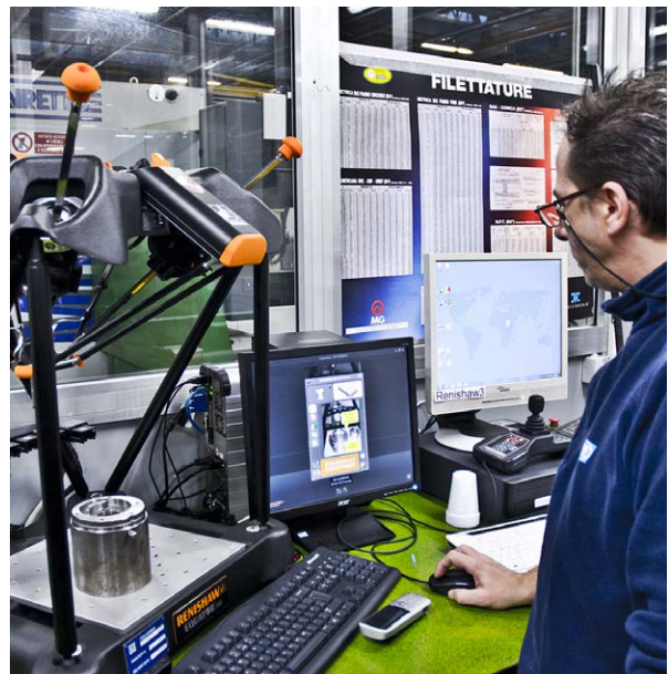
一名操作人員在 Equator 檢具系統上量測工件
