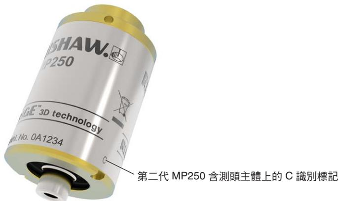
第二代 MP250 相容於 HSI 及 HSI-C 介面應用。第二代 MP250 的完整功能在結合 HSI-C 介面後將能徹底實現。搭配 HSI-C 的應用能讓使用者為測頭選擇適當的保護等級，防止因機器振動或加速導致的誤觸發。
