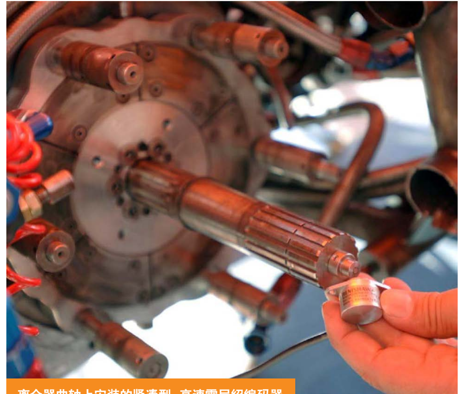
离合器曲轴上安装的紧凑型、高速雷尼绍编码器
