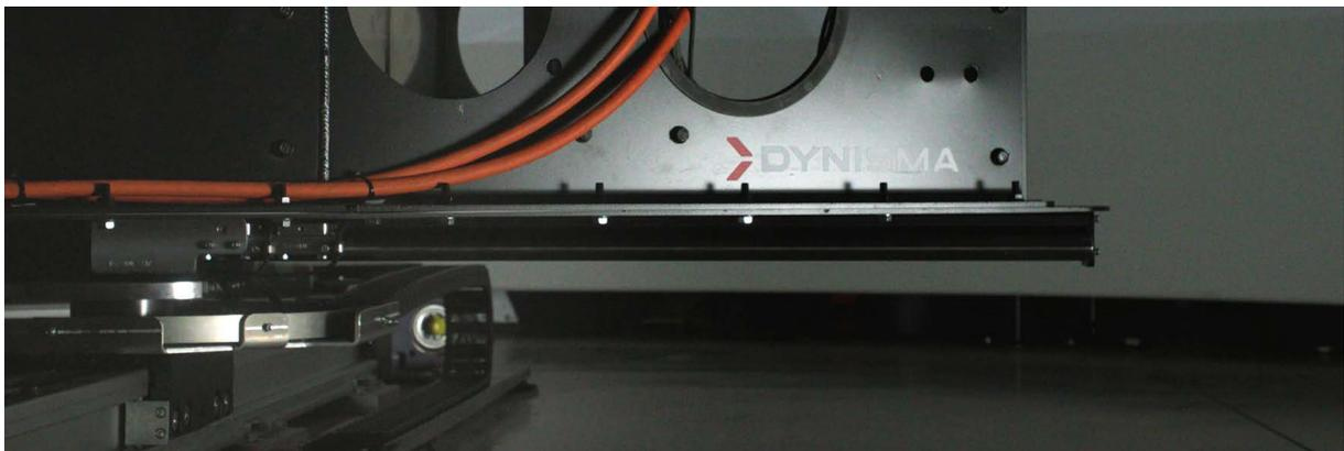
LFP 由三個皮帶驅動執行器（地軌）組成
