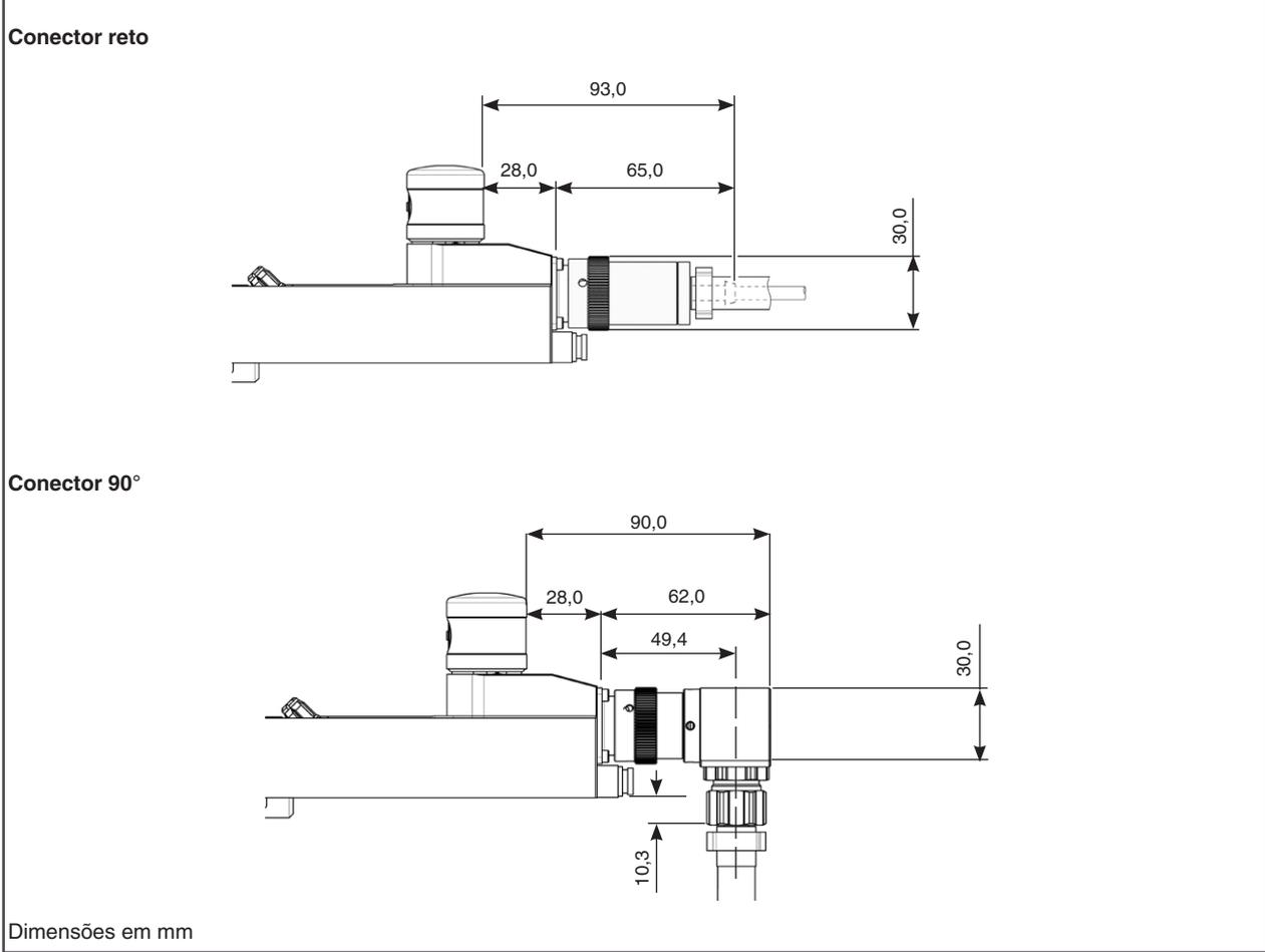
**Dimensões e montagem da placa de ajuste NC4+ Blue**
