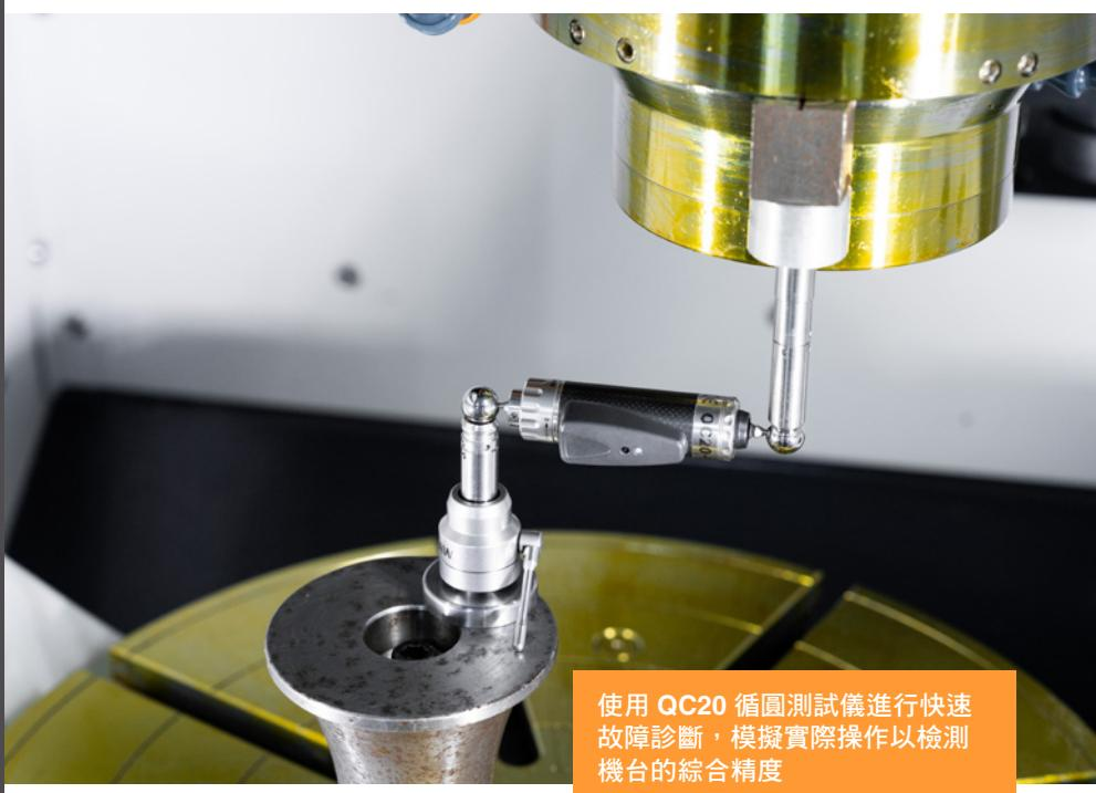
使用 QC20 循圓測試儀進行快速故障診斷，模擬實際操作以檢測機台的綜合精度
