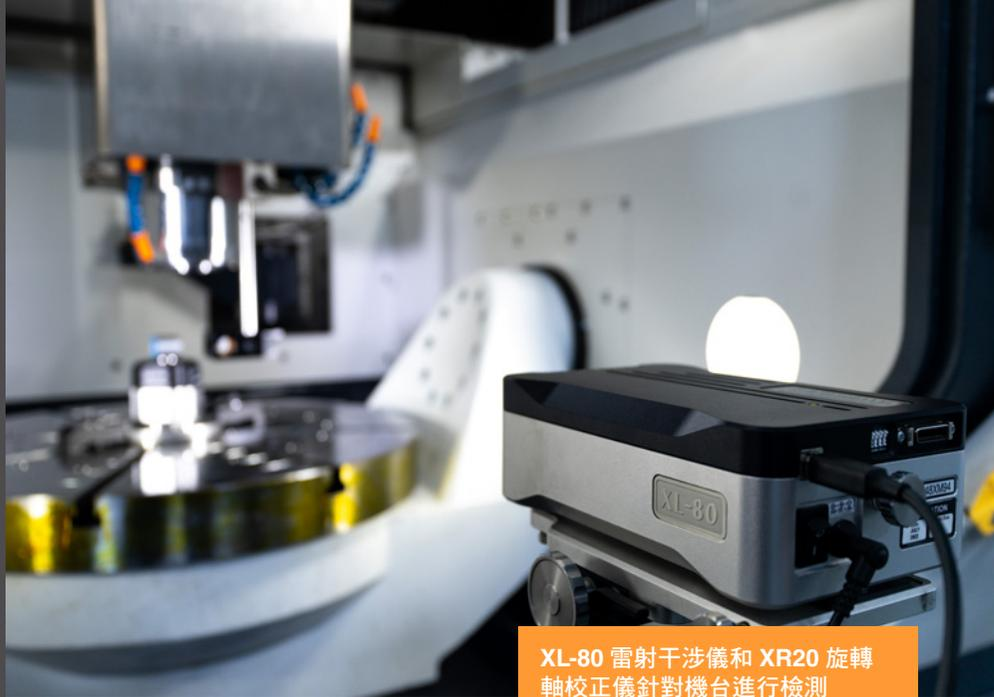
XL-80 雷射干涉儀和 XR20 旋轉軸校正儀針對機台進行檢測
