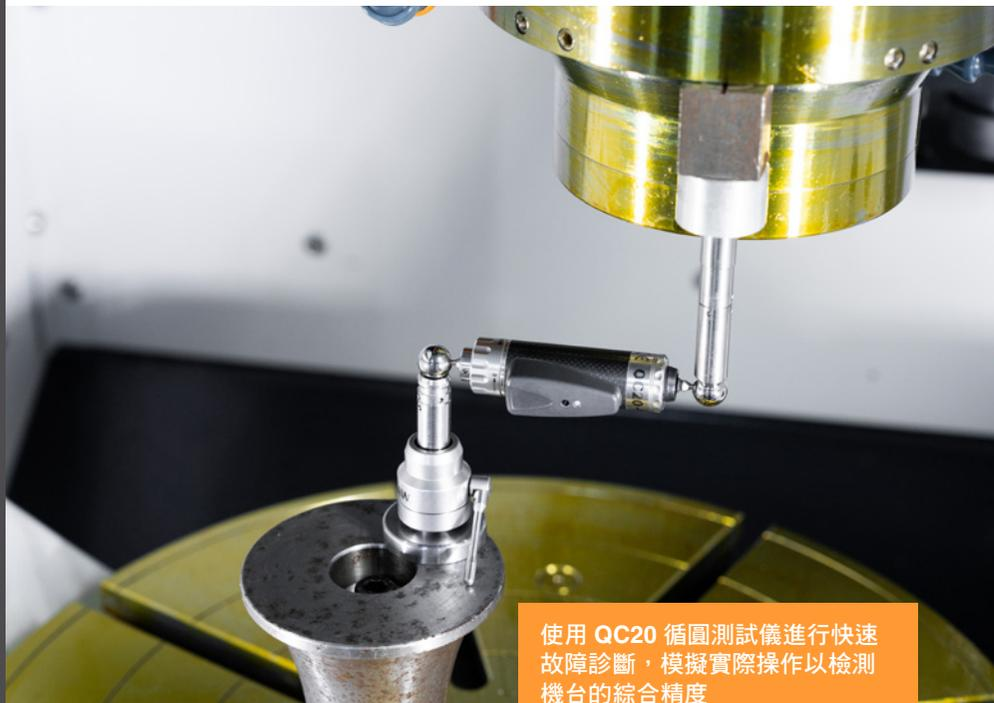
使用 QC20 循圓測試儀進行快速故障診斷，模擬實際操作以檢測機台的綜合精度
