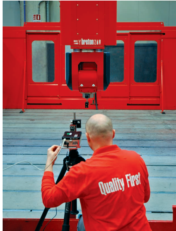
Een medewerker van Breton is bezig met de XL-80 laserinterferometer
