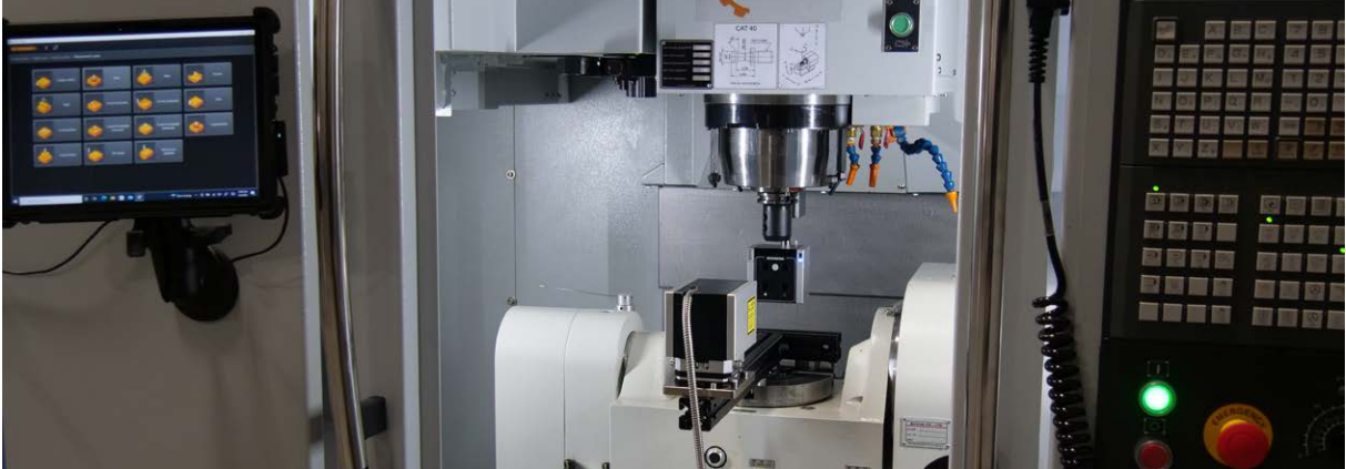
KES는 CNC 공작 기계와 CMM에서 XM-60을 사용하여 체적 보정을 수행합니다
