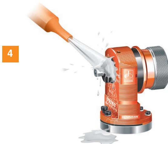
4 使用清潔用冷卻劑清洗測頭內部。
