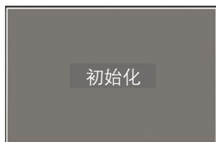
**注:** 如果您收到信息“Automation无法将错误初始化”,则表示与REN-IO接口之间的通信存在问题。请检查是否已连接REN-IO接口。请检查“AutomationSettings.xml”中的序列号是否正确。请检查“AutomationSettings.xml”中的序列号的顺序是否正确。
