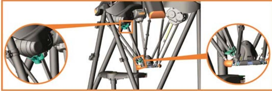
当用户关闭系统时, 或者每当系统触发自动关机时 (在更改以太网设置/更改日期和时间设置/更新软件时重启), 作为关机程序的一部分, 移动平台将移至停靠位置。
