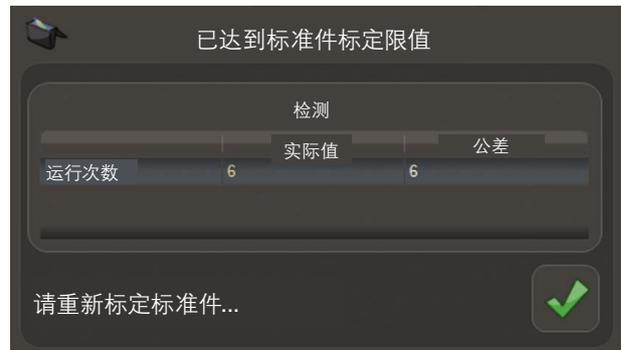
此图标显示已测量的工件数量。如果实际时间 (a) 达到所设定的限制条件 (b), 则将显示警告信息。当操作员点击绿勾后, Organiser将自动从“测量”模式切换为“标准件标定”模式。建议操作员此时重新标定标准件。
