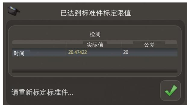
此图标显示截至当前经过的时间 (以小时和分钟为单位)。如果实际时间 (a) 达到所设定的限制条件 (b), 则将显示警告信息。建议操作员此时重新标定标准件。
