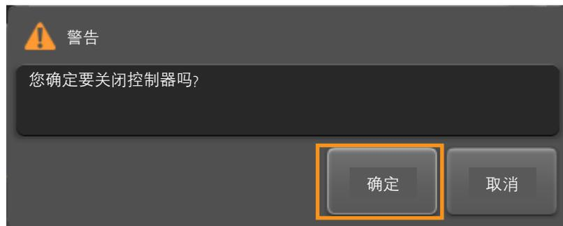
**注：**如果启用了停靠功能且存在对接机构，则Equator 300比对仪将在关闭前先停靠测头。
