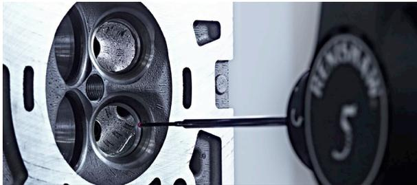
通過在同一台 5 軸三次元量床上整合表面粗糙度檢測和尺寸量測功能，許多汽車製造商成功將檢測週期縮短最高達 50%。
