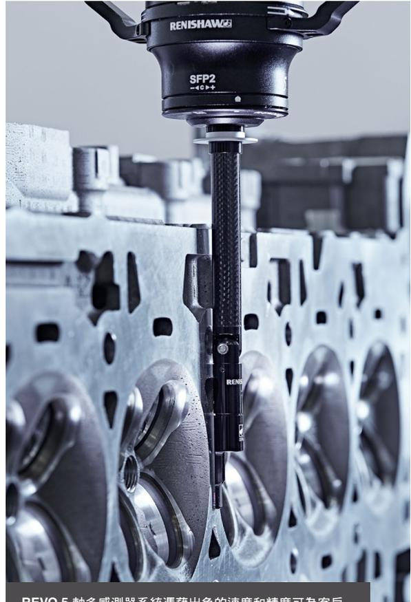
REVO 5 軸多感測器系統憑藉出色的速度和精度可為客戶節省可觀的產能，以便執行表面粗糙度檢測，以及檢測更多零件。
