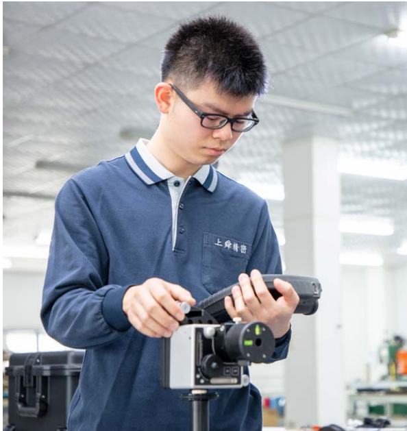
タブレットを使って XK10 のアライメント作業を行う Smooth Precision 社のエンジニア
