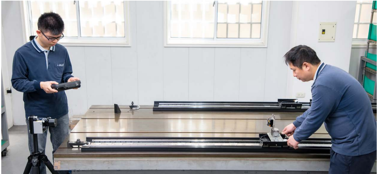
XK10 アライメントレーザーシステムを使った高精度リニアステージの検証作業の様子
