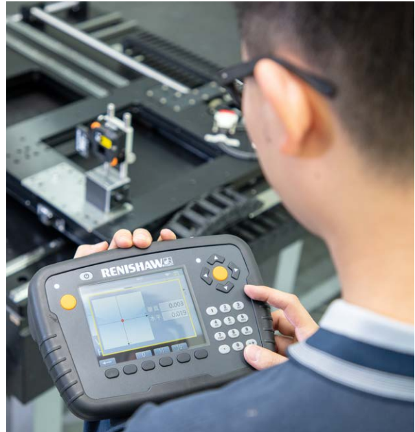
計測値はタブレットに表示されるため、値を見ながらの調整作業が可能
