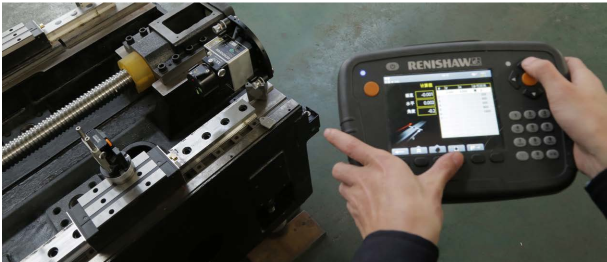
ワイヤレスで通信を行う XK10 アライメントレーザーシステム
