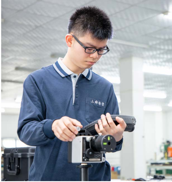
무선 디스플레이를 사용해서 XK10을 정렬하고 있는 Smooth Precision 엔지니어
