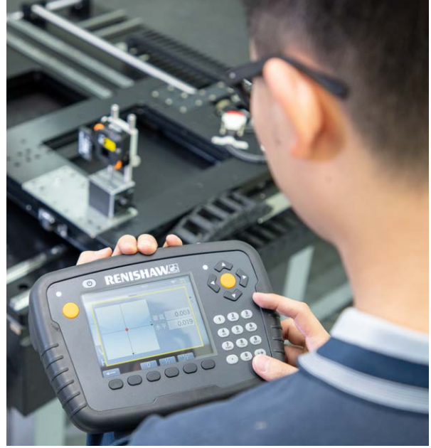
사용자의 즉각적인 조정이 가능하도록 측정값을 기록하고 판독값을 즉시 표시하는 XK10 디스플레이 장치
