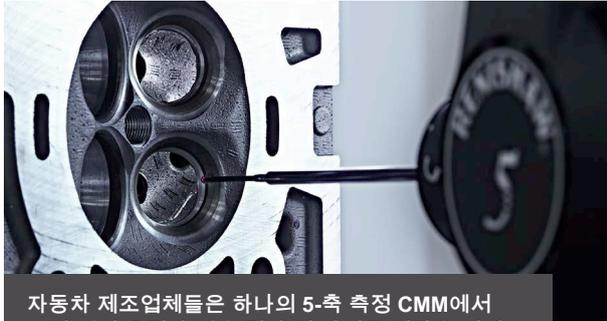
자동차 제조업체들은 하나의 5-축 측정 CMM에서 표면 처리 측정과 치수 검사 시 사이클 시간을 최대 50% 줄일 수 있습니다.
