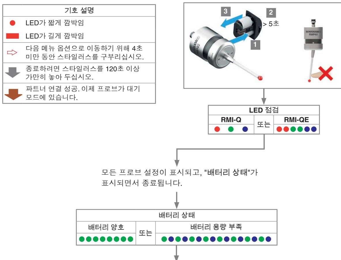
"배터리 상태"가 표시된 동안 스타일러스를 편향시키고 놓으면 "파트너 연결 모드"로 들어갑니다. 프로브 상태가 빨간색으로 깜박입니다.
