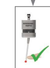
스타일러스를 편향시키고 검토 프로세스가 끝나면서 배터리 상태가 표시될 때까지 스타일러스가 편향된 상태를 유지합니다.
