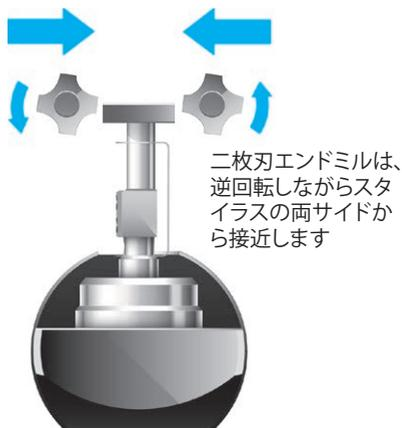
**注:** 回転工具径計測時には、プローブトリガーディレイを使用しないでください。
