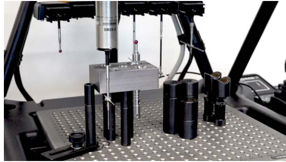
雷尼绍Equator比对仪正在检测一个NIMS认证所需的机加工零件
