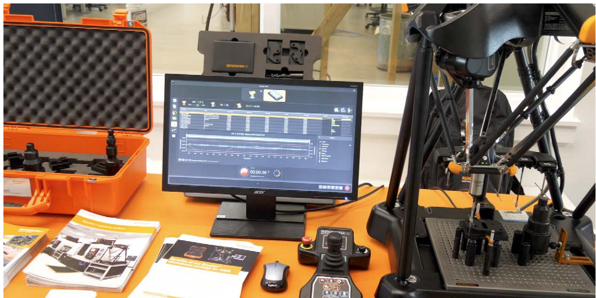
雷尼绍针对NIMS认证提供的Equator比对仪系统套装包括：预编程序、测针、两块测量夹具板，以及用于装夹所有13种零件的夹具
