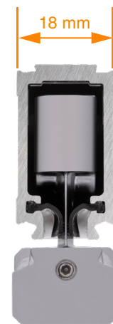
圖 3. FORTiS-S 和 FORTiS-N 光學尺殼體的縱斷面，顯示了非接觸式讀頭設計
