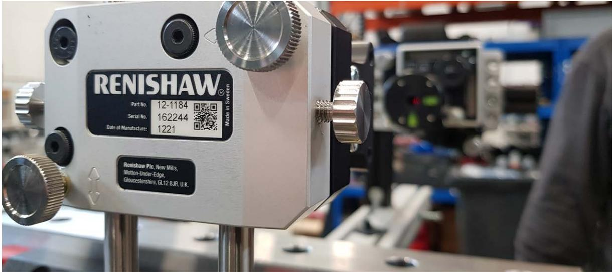
XK10 平行度套件已與機器軸校準完成
