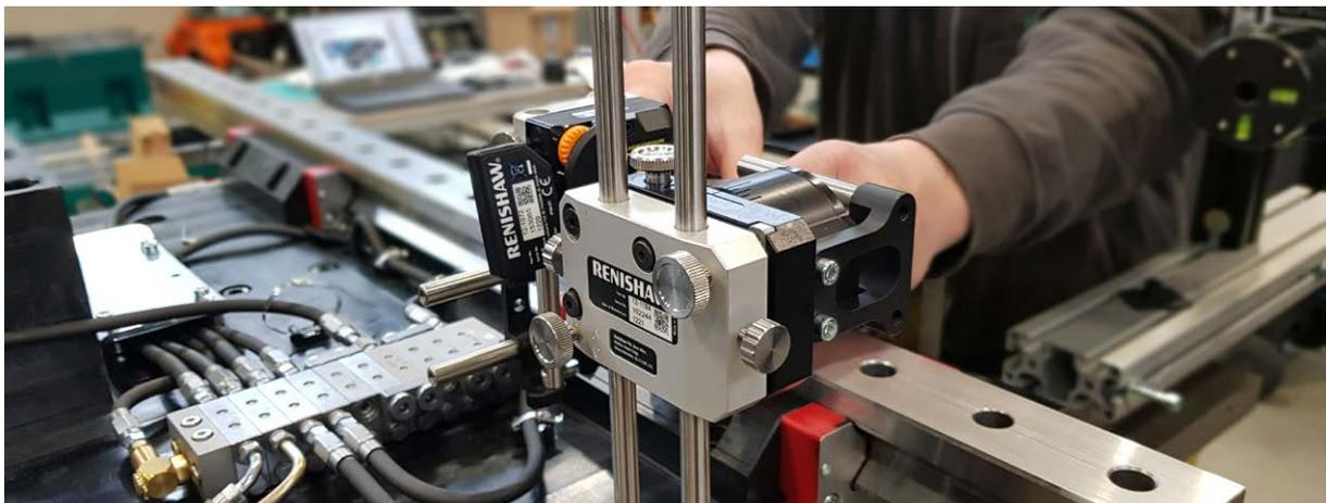
將 XK10 系統的五稜鏡校準以執行平行度測試
