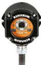
La sonda di presetting a trasmissione ottica OTS Renishaw, è robusta, compatta e senza cavi, per fornire la massima libertà ai movimenti del piano di lavoro. Supporta le funzioni di verifica dell'integrità degli utensili e di misura rapida di lunghezza e diametro.
