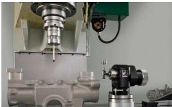
Un tipico sistema a doppia sonda include il presetting OTS e la sonda di ispezione OMP40-2, ma risulta compatibile con altri tastatori da mandrino con trasmissione ottica modulata. Il design del presetting senza cavi è particolarmente adatto alle macchine a doppio pallet o con tavole rotanti, nelle quali l'installazione di dispositivi cablati risulta sempre complessa.
