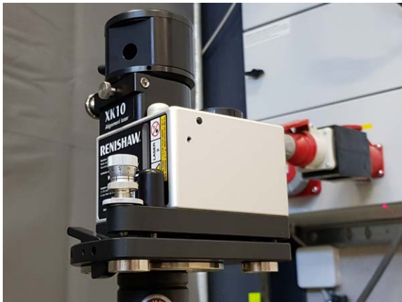
XK10发射器具有多功能夹具解决方案
