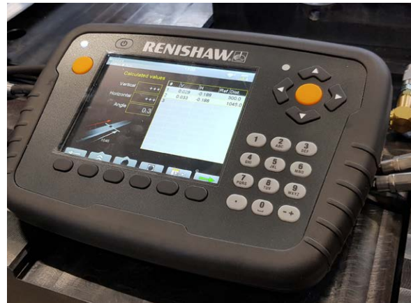
便携式XK10显示装置可提供实时反馈
