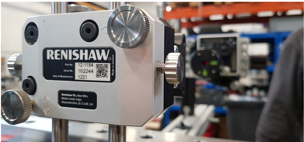
XK10平行度组件已与机器轴准直
