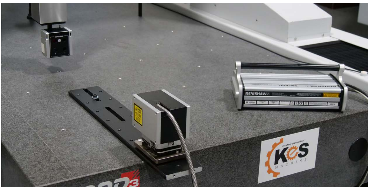
三次元測定機上のレニショー XM-600 マルチ軸キャリブレーションプレート
