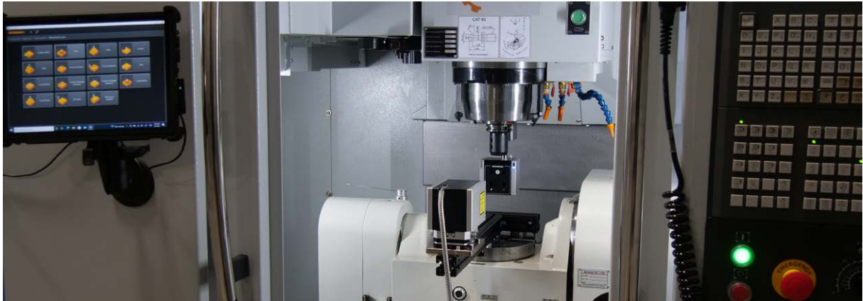
XM-60 は KES 社において CNC 工作機械と三次元測定機の空間補正に使用されている
