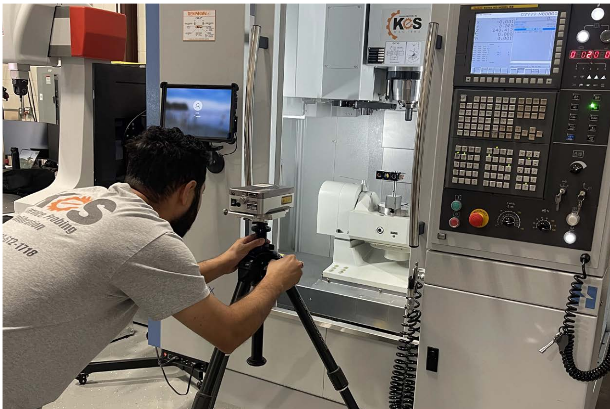
CNC 工作機械と XL-80 レーザーシステム
