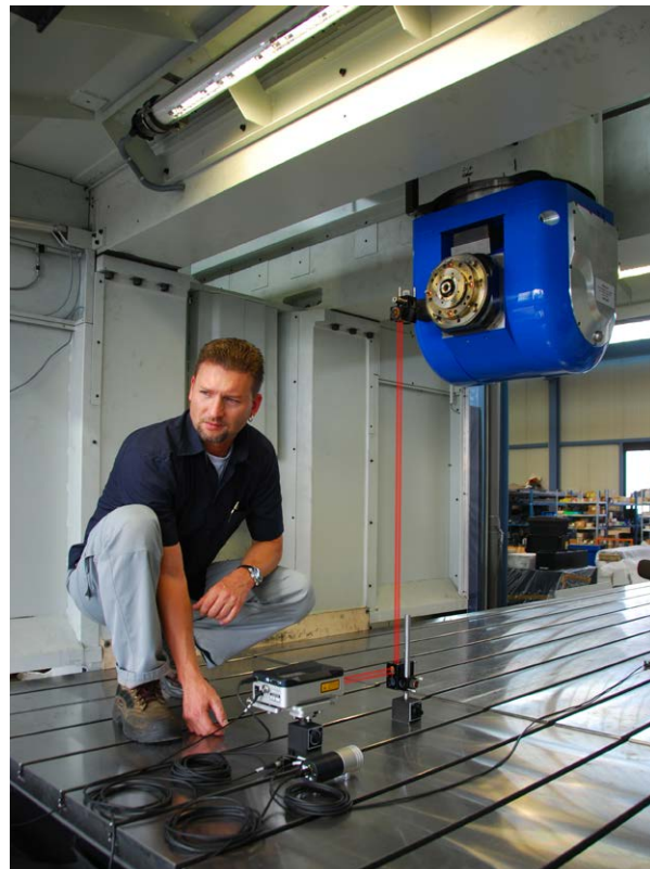
Jürgen Emslander puede verificar la precisión en el XL-80 compacto en muchas más posiciones, incluso dentro de máquinas como ésta Edel
