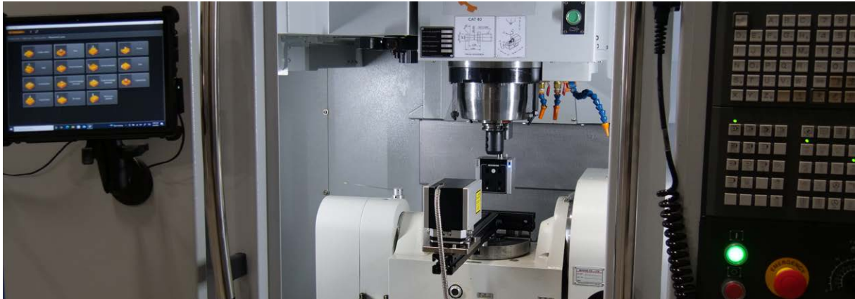
KES gebruikt de XM-60 op zijn CNC-bewerkingsmachines en CMM's om volumetrische compensatie uit te voeren
