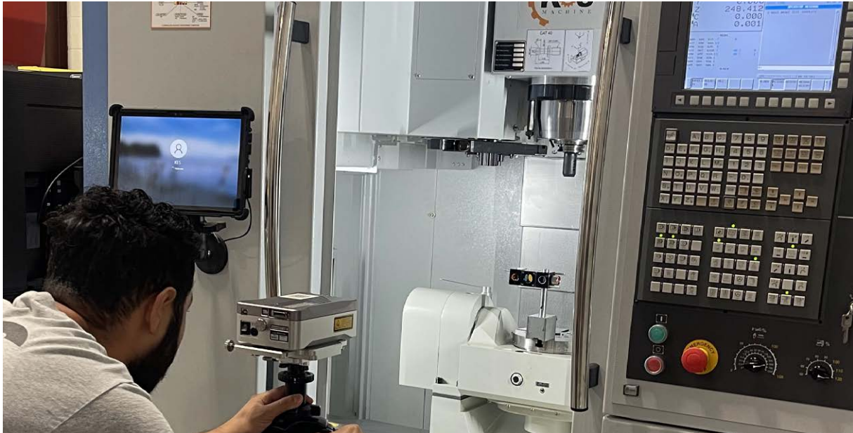
Renishaw XL-80 lasersysteem op een CNC-bewerkingsmachine
