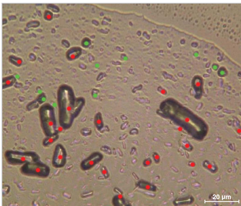
离散点成像：鼻喷剂液滴中单颗粒的快速、靶向分析。图像揭示药物和赋形剂相对于其白光图像的位置。
