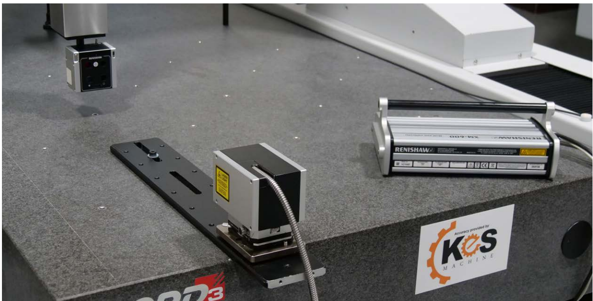
雷尼绍XM-600多光束激光干涉仪在坐标测量机上运行测试
