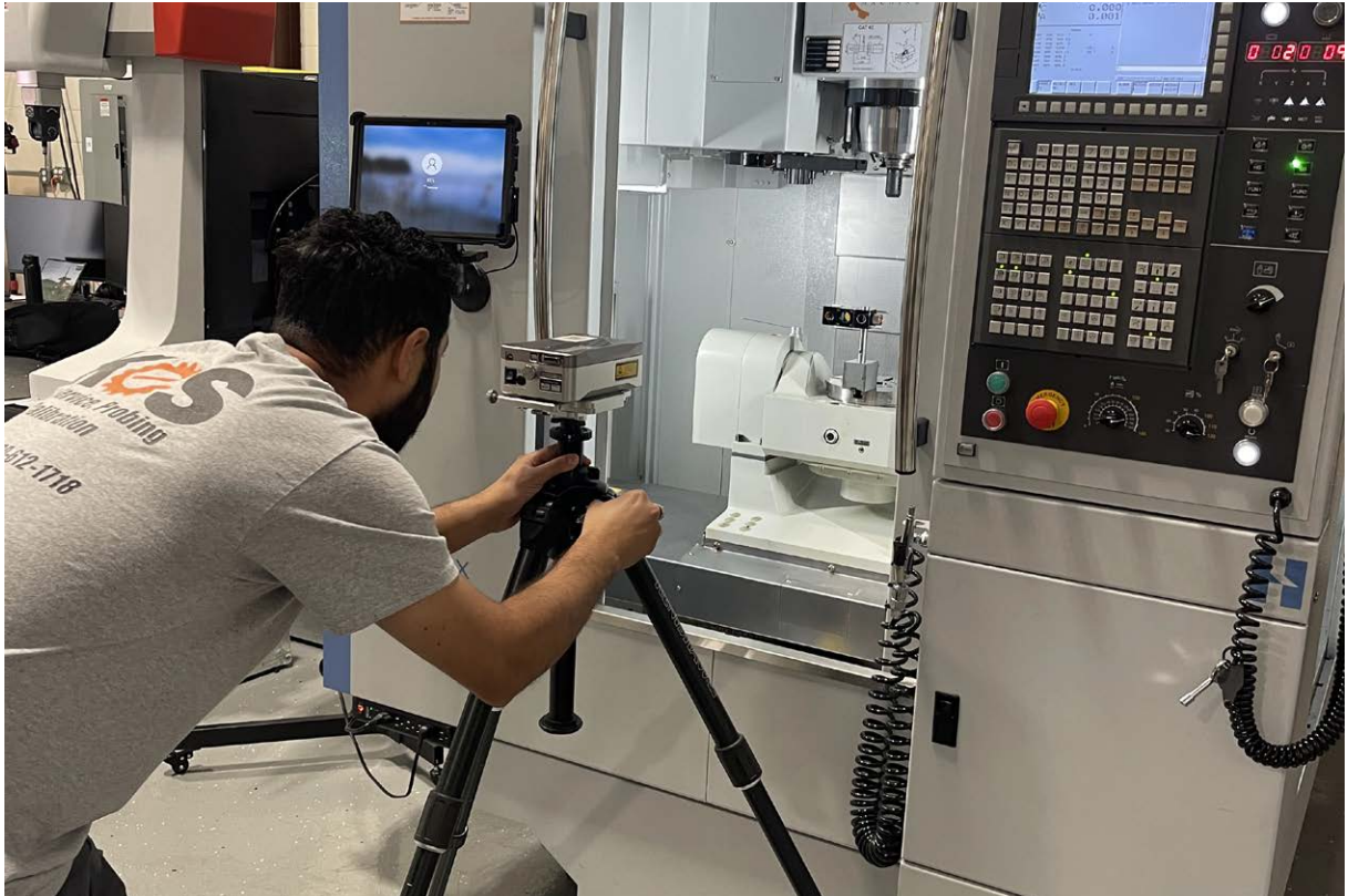
在数控机床上应用雷尼绍XL-80激光干涉仪
