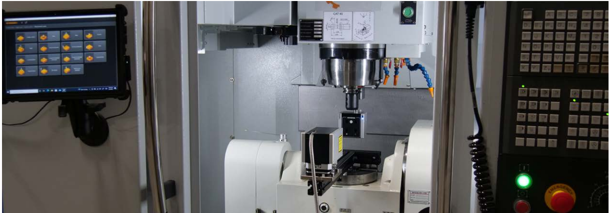
KES在数控机床和坐标测量机上使用XM-60多光束激光干涉仪执行空间补偿
