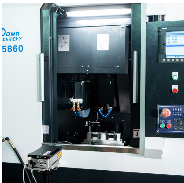
XL-80 laserinterferometersysteem in gebruik om de dynamische nauwkeurigheid te testen van de bewerkingsmachines van Dawn Machinery
