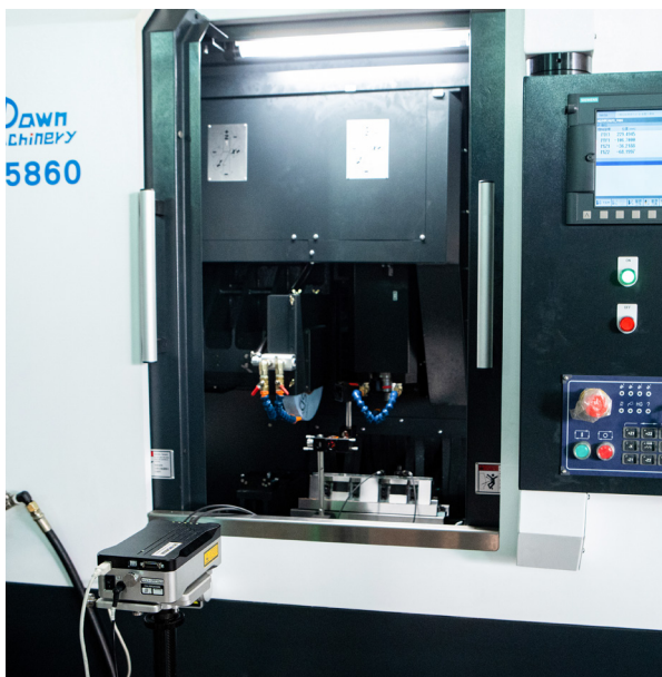
Dawn Machinery 공작 기계의 동적 정확도 검사에 사용된 XL-80 레이저 간섭계 시스템
