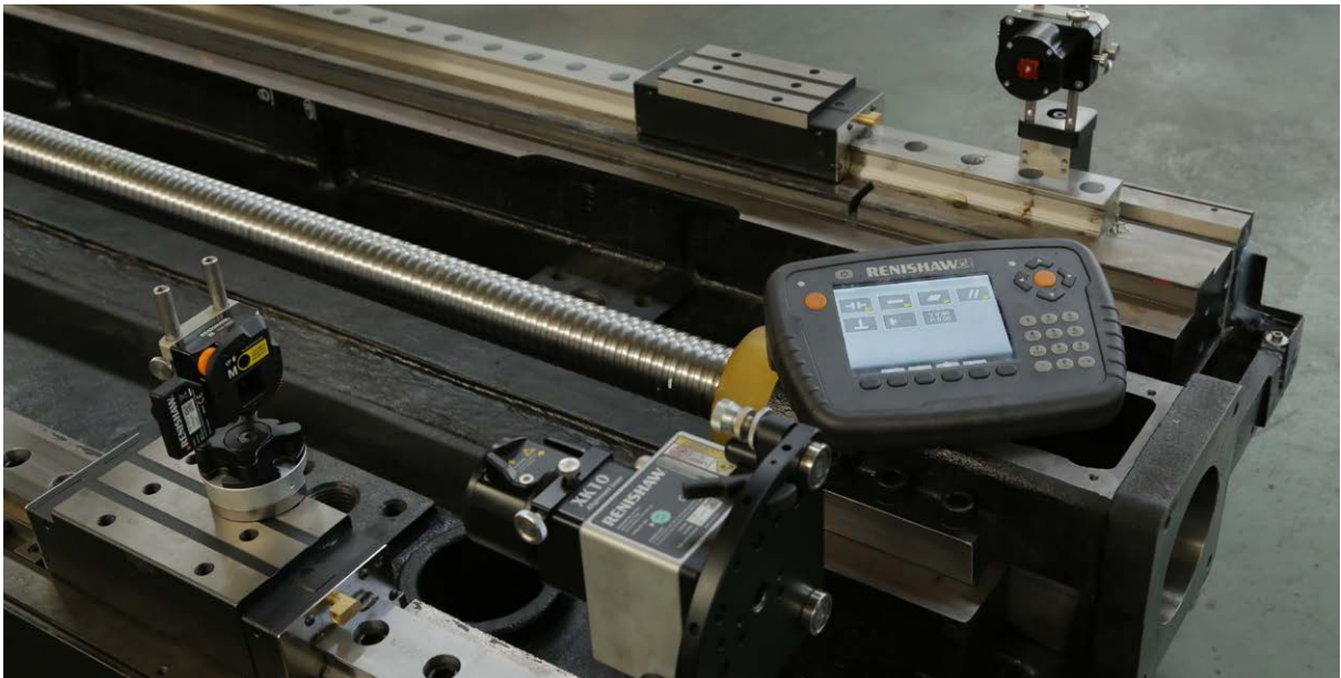
İki kılavuz rayının paralelliklerini ölçmek için XK10 kullanılırken
