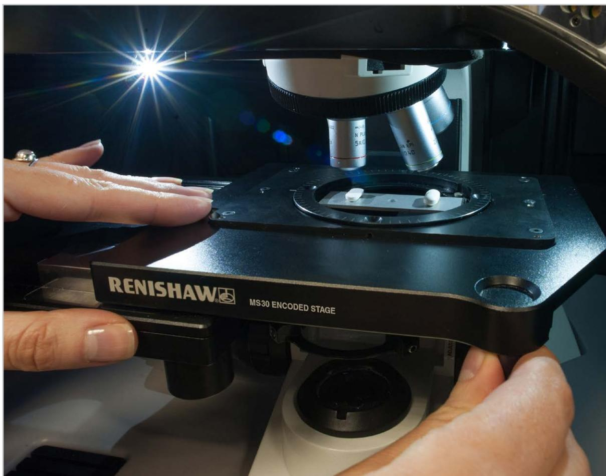
Патентованный моторизованный столик компании Renishaw использует датчики положения для отслеживания его положения, даже если вы перемещаете его вручную.
