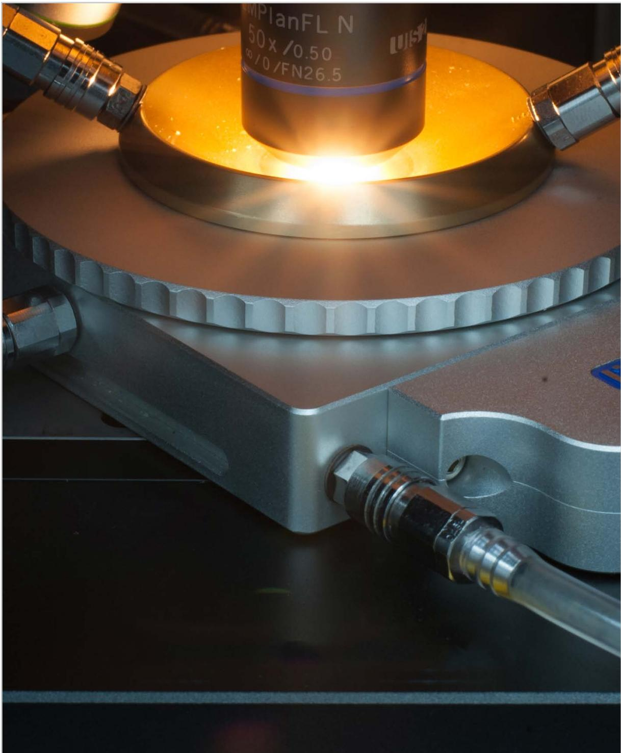
Выполнение автоматизированных рамановских измерений при высоких температурах (до 1500 °C).
