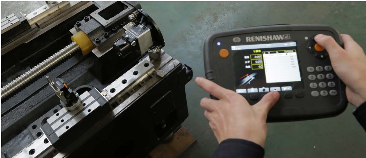
무선 통신 기술을 사용하는 Renishaw XK10 정렬 레이저 시스템
