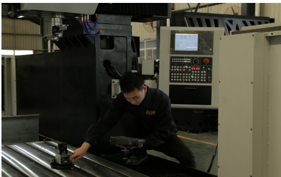
透过XK10进行垂直度测量
