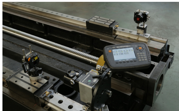
雷尼绍XK10激光校准仪采用无线通信
