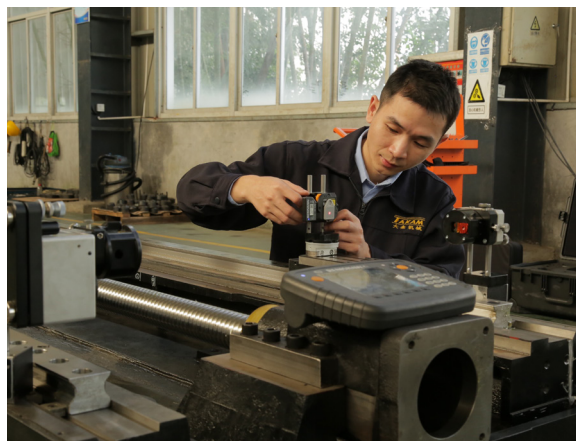
透过XK10进行双轨平行度测量
