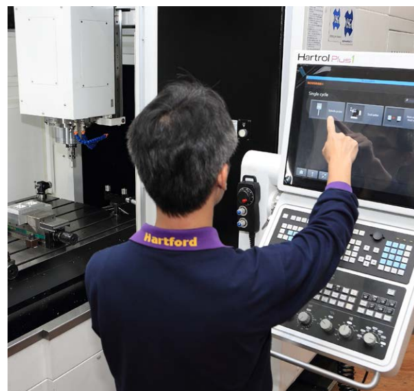
Aplikacija za mašine Set and Inspect integrisana u CNC-kontroler Hartrol Plus
