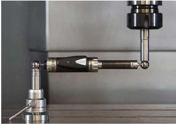
Hartford koristi Sistem Renishaw QC20-W ballbar za kontrolu kapaciteta pozicioniranja mašine
