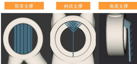
在加工文件处理软件中生成的辅助支撑类型。选择支撑时应考虑最大程度减少加工时间和序后处理成本。
