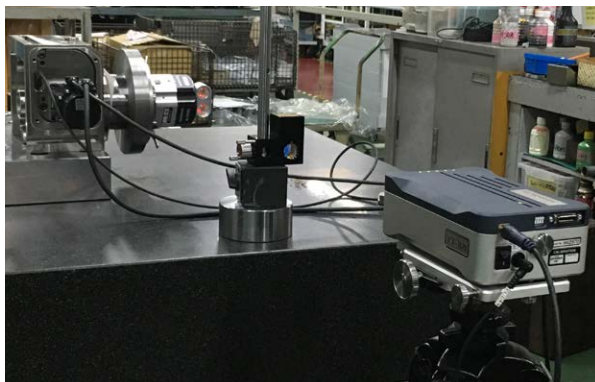
Inspección previa a la entrega en calibrador XR20-W con sistema láser XL-80 de Renishaw
