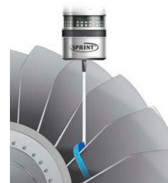
Сбор данных при измерении сечения лопаток
