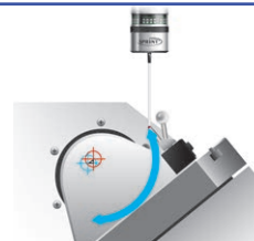
Проверка поворотных осей станка
